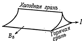
Фиг. 4.24. Форма образца для термомагнитного охлаждения.
