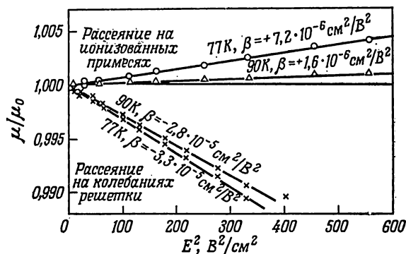
Фиг. 4.35. Подвижность носителей в двух образцах n -Ge с различными концентрациями примесей как функция квадрата напряженности внешнего электрического поля при 77 и 90 К [59].
